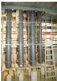
Columnas de biolixiviación: tratamiento de uranio a escala semipiloto.
