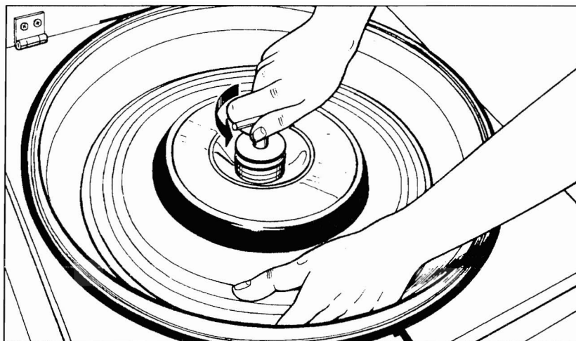
Fig.5 Aflojar el rotor en el sentido contrario de las agujas del reloj
