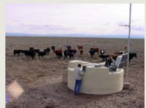
Las estaciones están construidas con material plástico resistente para poder aguantar las inclemencias del clima e incluso golpes severos. Una de las características del proyecto Pierre Auger es su integración en el entorno.
