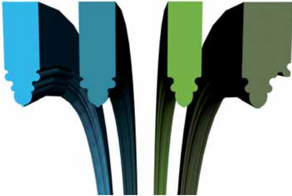
Secciones de nervios y arcos dispuestos en distintos ámbitos de la iglesia gótica
